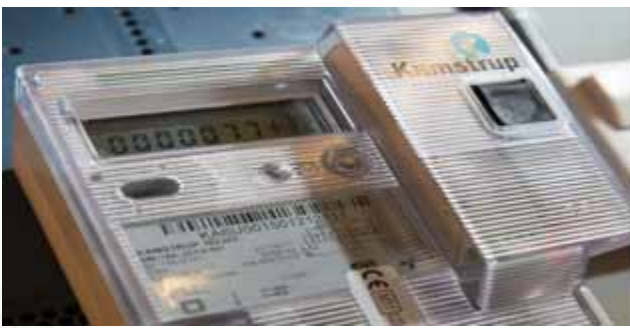
In de slimme elektriciteitsmeter zit de communicatiemodule
